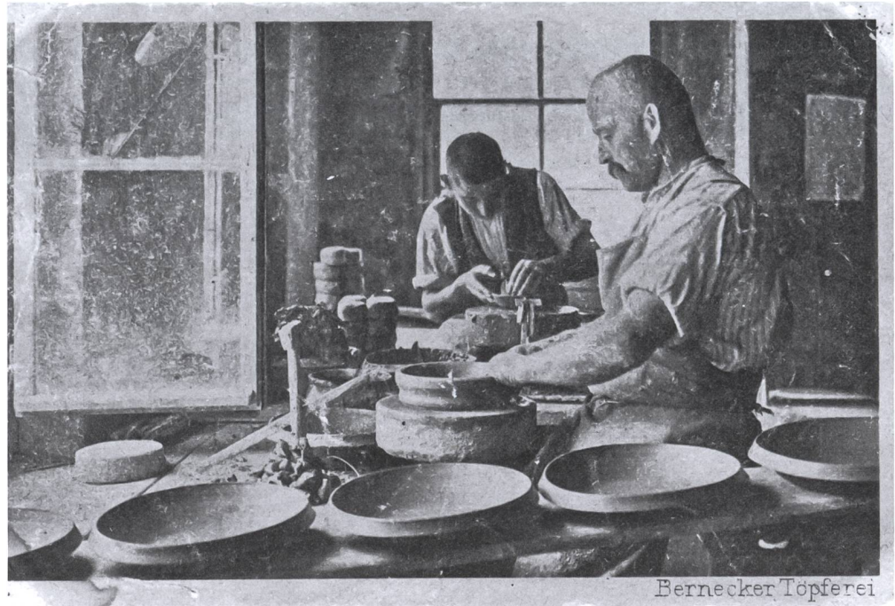
Abb. 6: Berneck SG, um 1920. Dreher an der Töpferscheibe bei der Herstellung von Rösti- platten mit scharfkantigem Kragenrand.
