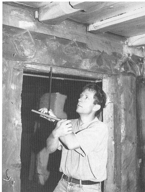
Abb. 64: Probenentnahme am verzierten Rähmbalken eines gotischen Prunkzimmers in einem hochmittelalterlichen Haus in Tinizong. Die Stube entstand nach den dendrochronologischen Daten im Jahr 1464.
