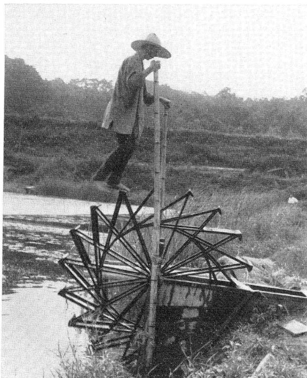
*Für die Bewässerung der Reisplantagen wird in Japan noch das primitive Wasserrad, das mühsam mit den Füßen bewegt wird, verwendet.*
