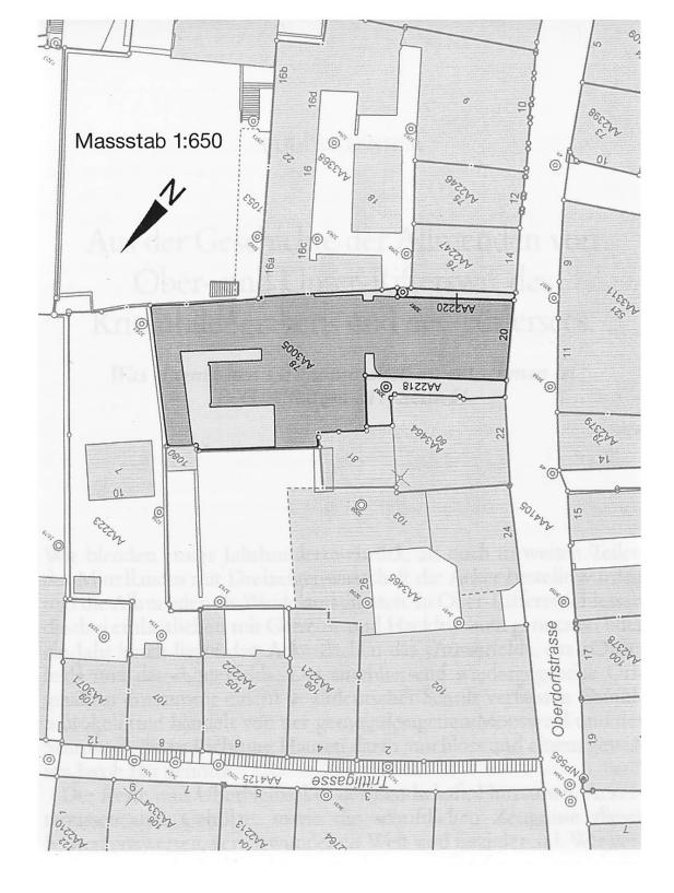
Abb. 10: Katasterplan, Msstb. 1:650, Amtliche Vermessung. Erklärungen: Kleine Zahlen in Gebäuden (z.B. 78 beim «Weissen Wind») Gebäudeversicherungs-Nummmern. Grössere Zahlen (z.B. AA 3005 beim «Weissen Wind») «Kataster-Nummern» (der Grundstücke), Zahlen bei Doppelkreisen (z.B. 3057, 3058 vor dem «Weissen Wind») Lagefix-Punkte. Copyright Geomatik + Vermessung der Stadt Zürich, Juli 2002.
