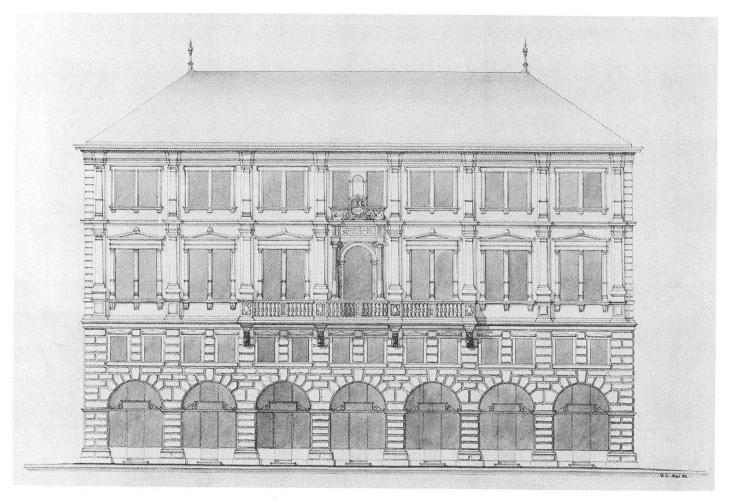
Abb. 4: Erster eigentlicher Fassadenentwurf von Georg Lasius, Mai 1863, der bereits die später verwendeten Elemente der Rundbogen im Parterre, des mit ihnen durch rustiziertes Mauerwerk zusammengehaltenen Mezzanin und den Mittelbalkon vor dem Hauptgeschoss zeigt.
