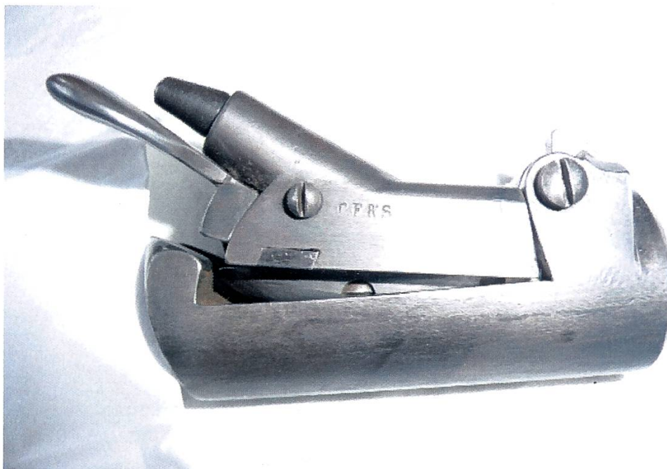
Umbausatz des Milbank-Amsler Systems für ein Vorderlader-Gewehr Kaliber 10,4mm
