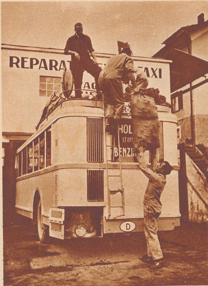
Es wird Holz getankt. Auf dem Dach des Wagens wird der Vorrat mitgeführt.
