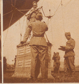
. . . . . es gelangt die Gondel zur Montage, welche mit den vielen Instrumenten, wie Baro- meter, Thermometer, Hygrometer, Anemo- meter, Feldstecher und Photoapparaten aus- gerüstet ist. Die Aufnahme hier zeigt den Korb, der nur zu Fesselballonzwecken benützt wird. Soll der Ballon motorisiert seinen Dienst er- füllen, so wird . . . . .
