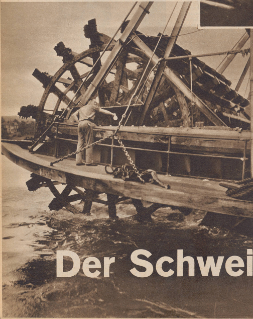
Unten: Vor der Ausfahrt aus dem Hafen wird das ganze Schiff gespritzt und geschmiert. Am meisten Sorgfalt wird dabei auf das große Heckschiffelrad verwandt, das die Besatzung «das Herz des Bootes» nennt. En bas: Avant chaque départ, le bateau est l'objet d'une minutieuse révision. La roue à aubes, cœur du bâtiment, est naturellement l'objet des soins particuliers.
