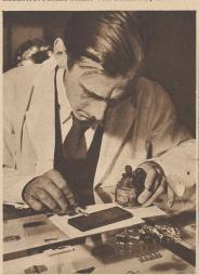
Kein Stück nimmt der Altgoldhändler entgegen, ohne es einer ganz genauen Prüfung zu unter-ziehen. Es geschieht mit Hilfe der Lupe, der Feile oder einer chemischen Lösung.
