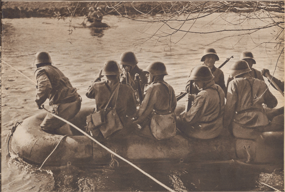
Schlauchboot zum Uebersetzen der Mannschaft im Fluß. Ein solches Gummiboot wird von zwei Pontoniersoldaten bedient und faßt sieben Mann mit Bewaffnung. Mit der ersten Uebersetzung wird gleichzeitig ein Seil gespannt, mit dessen Hilfe die folgenden Boote schnell und sicher hinüber gelangen. La première patrouille d'infanterie qui se porte en avant a traversé la rivière au moyen d'un radeau de caoutchouc. Installé une corde sur l'autre rive qui permettra aux patrouilles qui suivent de franchir plus rapidement le cours d'eau. III 2267 Ro
