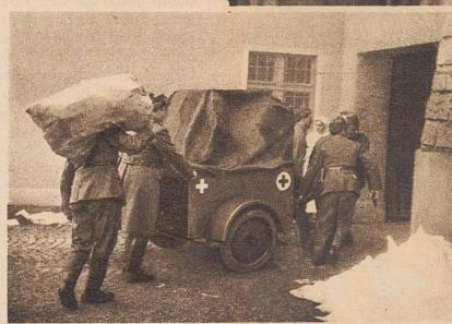
Eines der wichtigsten Geräte der Ambulanz, der Feldsterilisator, der als Anhänger konstruiert ist, wird in Stellung gebracht. Er dient zum Sterilisieren der Instrumente und der Operationswäsche.
