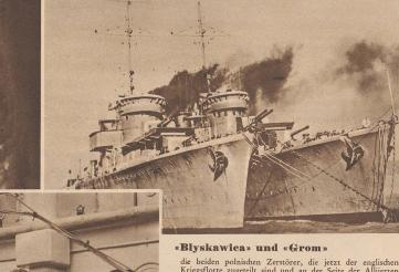
die beiden polnischen Zerstörer, die jetzt der englischen Kriegsflotte zugeteilt sind und an der Seite der Alliierten im Seekrieg stehen. Es waren die größten und modernsten Einheiten der polnischen Kriegsflotte, rund 2000 Tonnen groß, mit je 7 Geschützen von 12 cm und 6 Torpedorohren bestückt, im Jahre 1936 in Dienst gestellt.
