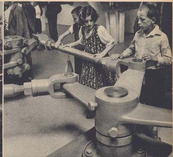
Gestänge einer Kaplanturbine zur Regulierung der Wassermenge. Mit diesen schweren metallischen Gelenke n werden die Leitradschaufeln eingestellt und dem Wasser ein größerer oder kleinerer Durchgang gewährt. Bras de commande d'un distributeur conique d'une turbine Kaplan.
