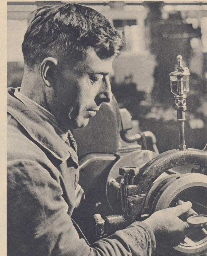
Spiegelt sich in dem Ausdruck des Arbeiters, der die Bohrung der Zylinderbüchse präzis auf ein Tausendstel-Millimeter schleift, nicht das souveräne Bewußtsein höchster Pflichtstreue? L'ouvrier, chargé de l'alésage des cylindres, concentre toute son attention sur son travail. Il ne lui est pas permis de faire erreur d'un millimètre.
