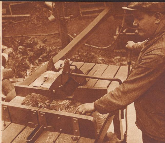
Beim Arbeiten mit der Schutzvorrichtung «Hatt» steht der Fräser neben dem Tisch. Mit einem Hebel führt er das festgeklebte Rundholz dem Fräsenblatt entgegen. Ein Kontakt mit der scharfen, rotierenden Säge ist ausgeschlossen. Das Wegschlagen von Holzstücken ist unmöglich geworden.
