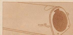
Geneigte Vorderseite + Staubbeutel kann nicht von selbst aus dem Apparat fallen, wenn der Deckel abgenommen ist.
