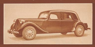
Citroën 6 Zyl. obengesteuert, 140 km. Reisedurchschnitte b. 100 km/Std., Frontantrieb, Schwingachsen, Torsionsstab-Federung, Teleskop-Stoßdämpfer, selbsttragende Ganzstahlkarrosserie. — Verl. Sie Kataloge, Probefahrt u. die Wettbewerbsbestimmungen beim zuständigen Citroën-Vertreter od. bei der Generalvertretung
