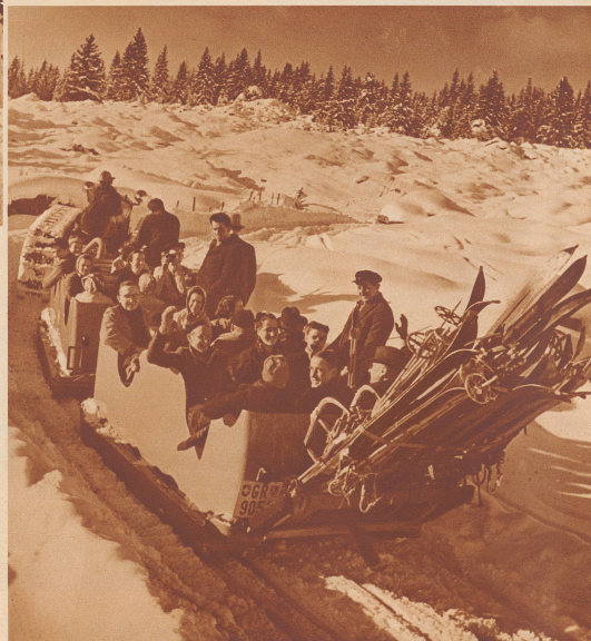
Aufwärts und um die Kurve. Nach Foppa soll's gehen auf 1500 Meter Höhe. Flims liegt 1100 Meter hoch. Die Entfernung beträgt 2,7 Kilometer, 26 Prozent beträgt die Steigung an der steilsten Stelle, die nimmt der Motor noch im dritten Gang. Fünf Gänge hat er und ist, wie das Ganze, auch eine Neukonstruktion des Erbauers. Die Motorkraft kann in den Kurven mittels sinnreicher Konstruktion von dem inneren Antriebsrad wegverlegt und aufs äußere Rad und aufs äußere Raupenband gesammelt werden. Die ungleiche rasche Gangart der beiden Raupenbänder schiebt den Traktor um die Wegbiegungen.
