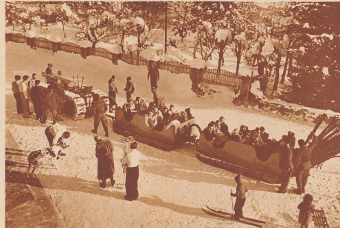
Die erste fahrplanmäßige Abfahrt in Flims-Dorf mit zahlenden Gästen. Man kam auf 45 Leute, statt nur auf 32, wie die Schlitten eigentlich fassen. Aber der Motor mit seinen 80 PS überwand alle Schwierigkeiten. Er heizt mit seinen Auspuffgasen den Schlittengängen die Füße. Deutlich sieht man das gebogene Leitungsrohr vom Traktor zum ersten und vom ersten zum zweiten Schlitten gehen. Die Schlitten sind ganz aus Metall mit Holzsitzen. Le départ de Flims. 45 passagers ont pris place dans ce premier convoi. Canalisés par un système de tuyaux — que l'on voit entre les traîneaux — les gaz du moteur de 80 HP du tracteur sont utilisés pour chauffer les pieds des usagers.
