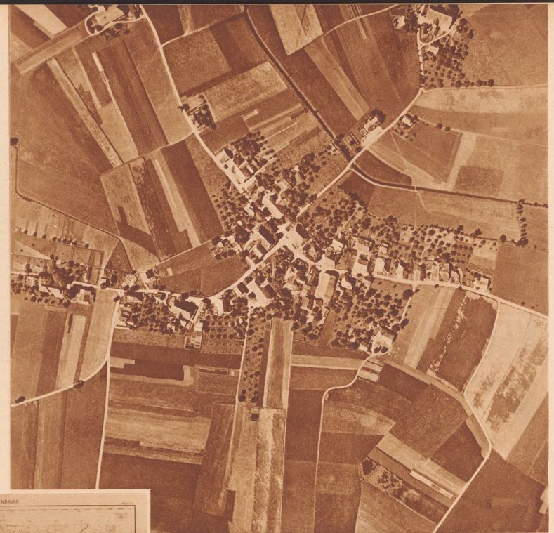
Eine Senkrechtaufnahme von Mattstetten (Blatt Hindelbank). Es betrifft Nr. 184 (direkt neben Nr. 123) des Flugplanes. Die günstigste Aufnahmezeit für die «Lufttopographen» ist die Mittagsstunde mit ihren kurzen Schatten. Le cliché photogrammétrique n° 184 (comparez le plan de vol): le village de Mattstetten.
