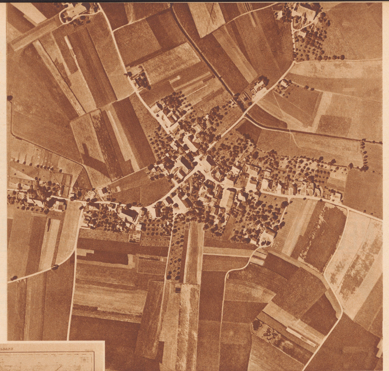
Eine Senkrechttaufnahme von Mattstetten (Blatt Hindelbank). Es betrifft Nr. 184 (direkt neben Nr. 123) des Flugplanes. Die günstigste Aufnahmezeit für die «Lufttopographen» ist die Mittagsstunde mit ihren kurzen Schatten. Le cliché photogrammétrique n° 184 (comparez le plan de vol): le village de Mattstetten.
