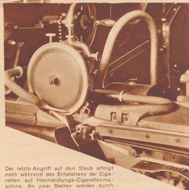
Wiederum führen Saugröhren den Tabak der Cigarettenmaschine zu. Aus zwei Öffnungen fällt er herab, aber nicht, ohne vorher noch einmal über einen Staubfilter zu gehen. Er ist in der Abbildung im geöffneten Teil der vorderen Zuführung sichtbar.
