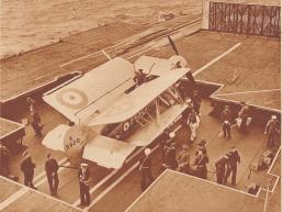
Ein Flugzeug wird in den Hangar versenkt. Um Raum zu sparen, werden die Flügel des Flugzeuges zurückge-faltet. So ist es mög-lich, 52 Maschinen im Bauche des Schiffes unterzubringen.
