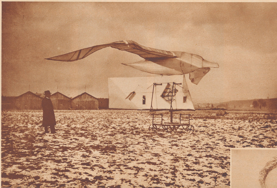
Flugversuchsmodell von 14 Meter Spannweite auf dem Dübendorfer Flugfelde. An diesem, dem Albatros nachgebauten, verspannungslosen Dickflügelmodell nahm der Flugforscher Carl Steiger im Winter 1913/14 auf dem Dübendorfer Flugfelde eine große Anzahl aufschlußreiche aerodynamische Versuche und Messungen vor. Links auf dem Bilde Carl Steiger. Im Hintergrund die Flugzeugschuppen.
