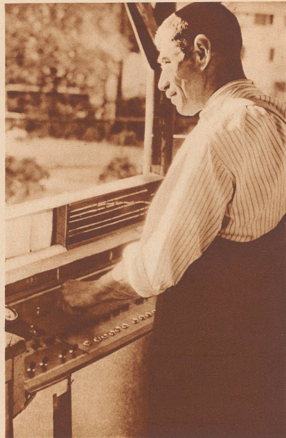
Herr Seiler leitet seine Lötschbergbahn von der Schalttafel aus. Er kann hier 14 Weichen stellen und 18 Spielleitungsschalter und verschiedene Signale bedienen.
