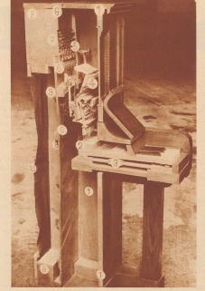
Das entzweigeschnittene Klavier steht in einem Schaufenster des Pianohauses Jecklin in Zürich. 1 Gehäuse; 2 Tasten; 3 Klaviatur-Rahmen; 4 Mechanik mit Anschlaghämmern und Dämpfern; 5 Stimmwirbel und Saiten; 6 Panzerstimmstock (Gußplatte); 7 Stimmstock; 8 Rasten; 9 Resonanzboden mit Saitenauflage (Steg); 10 Rückwand.
