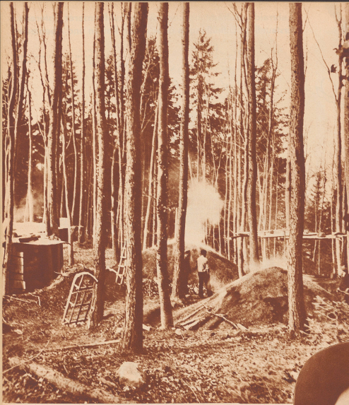
Die Kohlenmehler im Wald von Chamorens, kanton Ollon. Holzkohle wird durch Verbrennen von Holz - irgendwelcher Art - bei Luftabschluss hergestellt. Zu diesem Zwecke werden Holzkohle - 25 bis 40 m 3 - in kugelförmigen Haufen (Steinmehler) und mit Erde umgeben. Dann wird das Holz in Brand gesetzt und unter Verhinderung eines kleinen Teiles des Holzes bei passendem Luftzutritt die Verkohlung durchgeführt. Der Prozess dauert 3-7 Tage, dann ist aus dem Holz Kohle geworden. Das Holz wird 3-4 Wochen vor dem Einlegen in den Meiler präpariert und getrocknet. 100 kg luftgetrocknetes Holz ergeben 25-32 kg Kohle.
