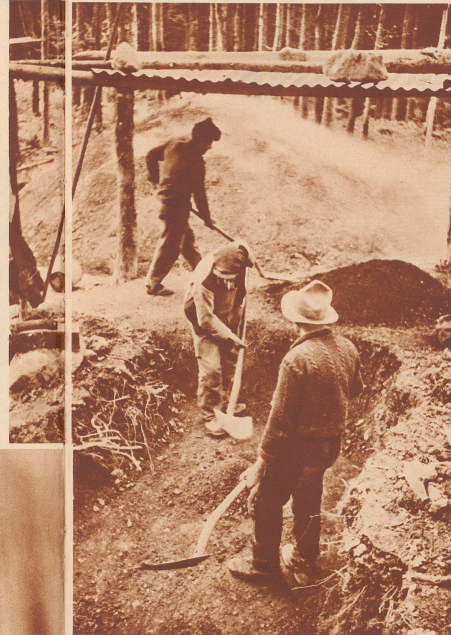
In einem Graben nebenan, im Regenschutze eines improvisierten Wellblechdaches, wird die Deckerde, die ganz fein sein muß, für den Meiler vorbereitet. Sous un abri improvisé, on prépare soigneusement la terre qui servira à recouvrir la meule.
