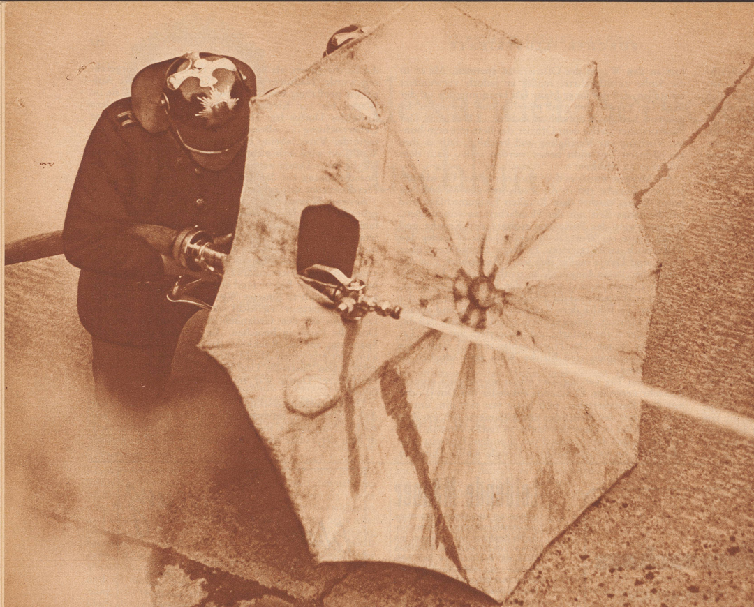
Der Asbestschirm gestattet den Feuerwehrmännern, dem Feuer nahe auf den Leib zu rücken. Asbest ist unverbrennbar und läßt die Hitze nicht durch.
