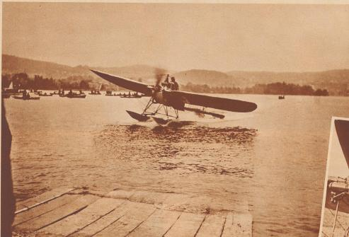
Im August 1912 machte Grandjean mit seinem durch Ersetzen der Fahrräder mit zwei Schwimmern in ein Wasserflugzeug umgewandelten Eindecker auf dem Zugersee die ersten Versuche, die vollauf gelangen. Am 4. September 1912 überflog er in 56 Minuten, 16 Sekunden den Genfersee von Childon nach Versoix und gewann damit den Eynard-Peries von 10 000 Franken. Bild: Eine Wasserlandung Grandjeans auf dem Zürichsee im Oktober 1912.
