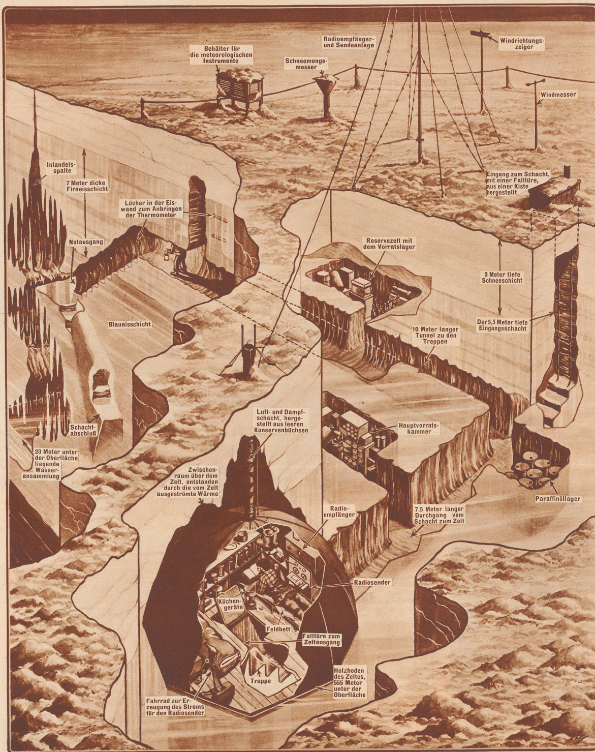
Blick in die Eisdeckenstation der «Oxford University Arctic Expedition 1935/36» in Nordostland. Diese Zeichnung zeigt — zum Teil angeschnitten — die Anordnung der in die Eisdecke eingebauten Anlage. Mit den Grabarbeiten waren zwei Mann fünf Monate lang beschäftigt. Mehr als 40 Tonnen Eis mußten ausgehoben und an die Oberfläche geschafft werden.
