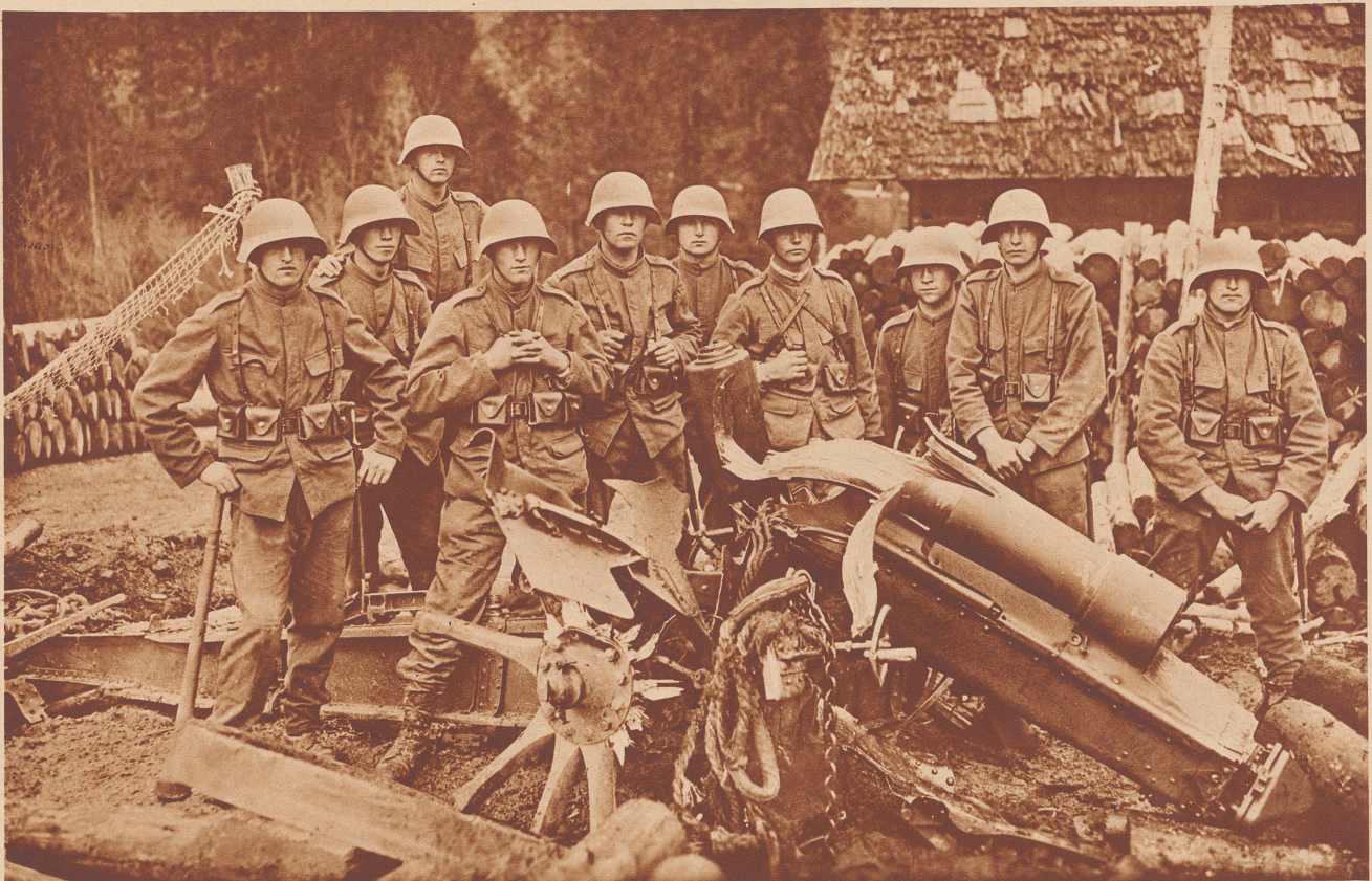
Das eine der zerstörten Geschütze. Rohr, Schutzschild, Verschuß, Schußbremsen, Richtmaschinerie und Räder sind total zertrümmert. Intakt geblieben ist die Lafette und zum Teil die Rohrwiege.
