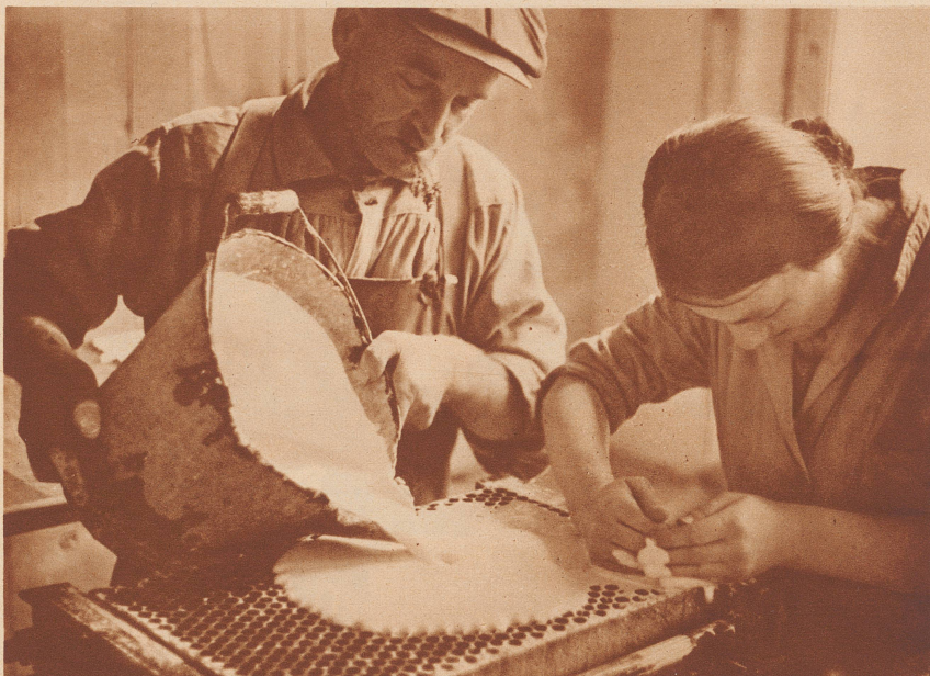
Die weißen und farbigen Kreiden, die euer Lehrer an der Wandtafel benützt, stellt man in der Schweiz auch künstlich her. Man verwendet dazu hauptsächlich Gips, das in flüssigem Zustande in Holz- und Metallformen gegossen wird. Sobald die Masse hart ist, werden die einzelnen fertig geformten Kreidenstücke aus der Negativform gelöst. Die Kreide enthält dann noch viel Wasser. Deshalb legt man sie noch eine Zeitlang zum Trocknen aus: Nachher ist sie um die Hälfte leichter.
