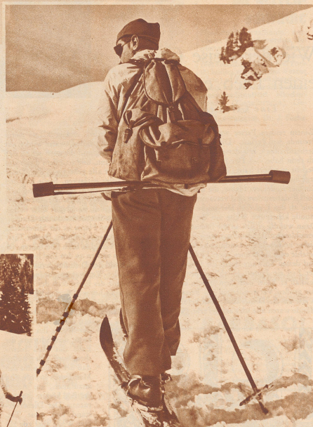
Ein Ausrüstungsgerät nur für Gebirgstruppen und nur für den Winterdienst: die Sondierstange. Sie dient dazu, um im Falle von Verschüttungen durch Lawinen sofort die Suche nach Verunglückten aufnehmen zu können. Die Sondierstange besteht aus mehreren Teilen, die bis zu einer Länge von vier Meter zusammengeschraubt werden können.
