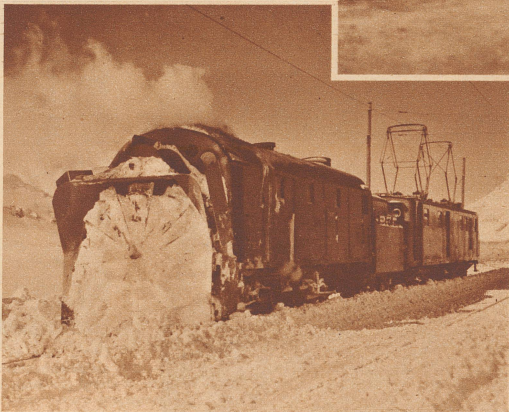
Die Dampfschleuder auf Bernina-Hospiz macht eine Atempause. Mit 1400 Pferdekräften bohrt sie sich in den hohen Schneewall und macht die Bahn von St. Moritz bis nach Poschiavo für die Vergnügungsreisenden frei.
