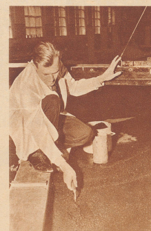
Das Auslagern der Flußläufe des Modells erfolgt von Hand mit Hilfe einer Kelle. In den bereitgestellten geeichten Gefäßen werden die abgelagerten Mengen genau gemessen.
