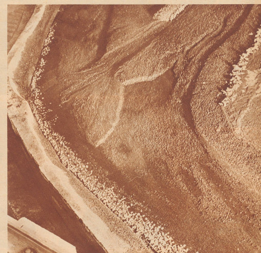
Das Auslagern der Flußläufe des Modells erfolgt von Hand mit Hilfe einer Kelle. In den bereitgestellten geeichten Gefäßen werden die abgelagerten Mengen genau gemessen.
