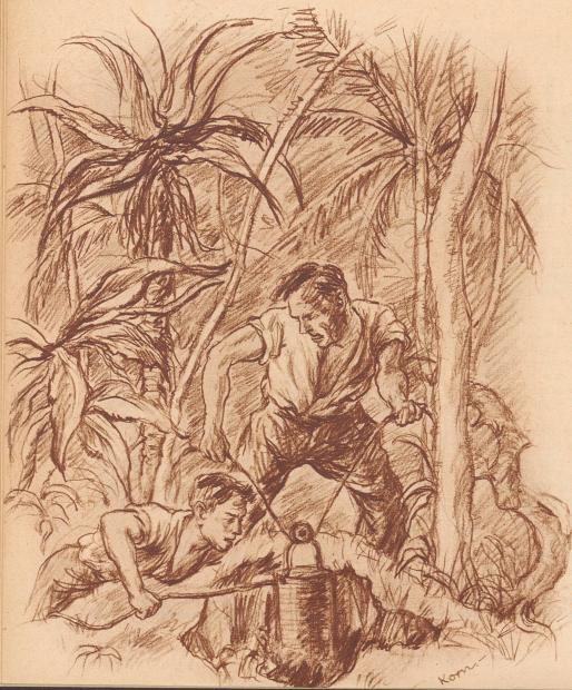
An einer geeigneten befindenen Stelle im Urwald wird ein Loch gebrägt und ein Sprengkörper tief in die Erde versetzt. Die Zündung erfolgt abseits von einer etwas entfernten Stelle aus. Von der Sprengstelle bis zu den Beobachtungsstellen, wo die Erschütterungsregistrierungen stattfinden, werden Leitungen erstellt, damit dort genau auch die Sprengzeiten markiert werden können.
