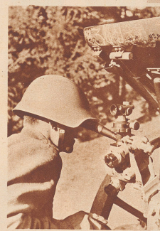
Der Richtier am Aufsatzfernrohr. Seine Arbeit erfordert größte Genauigkeit und Zuverlässigkeit. Das Schießen der Gebirgsartillerie erfolgt fast ausschließlich auf indirektem Wege. Das Aufsatzfernrohr ermöglicht es, auf dem Wege über ein beliebig gelegenes Hilfsziel das Geschützrohr auf ein unsichtbares Ziel zu richten.
