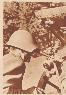
Der Richter am Aufsatzfernrohr. Seine Arbeit erfordert größte Genauigkeit und Zuverlässigkeit. Das Schießen der Gebirgsartillerie erfolgt fast ausschließlich auf indirektem Wege. Das Aufsatzfernrohr ermöglicht es, auf dem Wege über ein beliebig gelegenes Hilfsziel das Geschützrohr auf ein unsichtbares Ziel zu richten.
