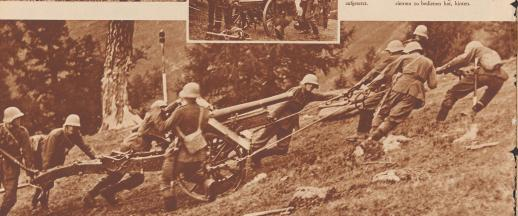
Das montierte Geschütz wird in Feuerstellung gebracht. Eine Manipulation, die im Gebirge oft mit großer Anstrengung für die Bedienungsmannschaft verbunden ist. Die für einen Stellungsbezug einer Gebirgsbatterie benötigte Zeit beträgt 15–30 Minuten.
