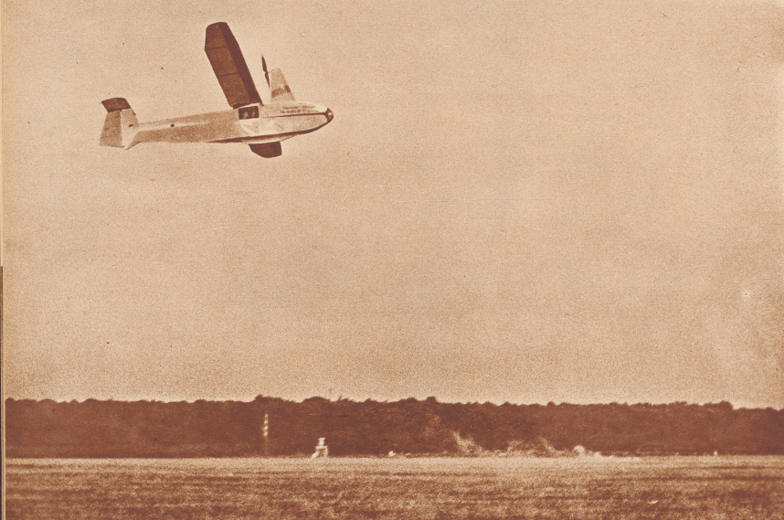
Ein Bild von welthistorischer Bedeutung. Die erste Aufnahme vom Menschenflug aus eigener Kraft. Zehn Meter über der Erde fliegt Dünneil mit etwa 10 Meter Sekundengeschwindigkeit dahin. Der Propeller macht 500 Umdrehungen in der Minute.
