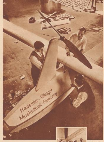
Ein Bild von welthistorischer Bedeutung, Die erste Aufnahme vom Menschenflug aus eigener Kraft. Zehn Meter über der Erde fliegt Dünnbeil mit etwa 10 Meter Sekundengeschwindigkeit dahin. Der Propeller macht 500 Umdrehungen in der Minute.
