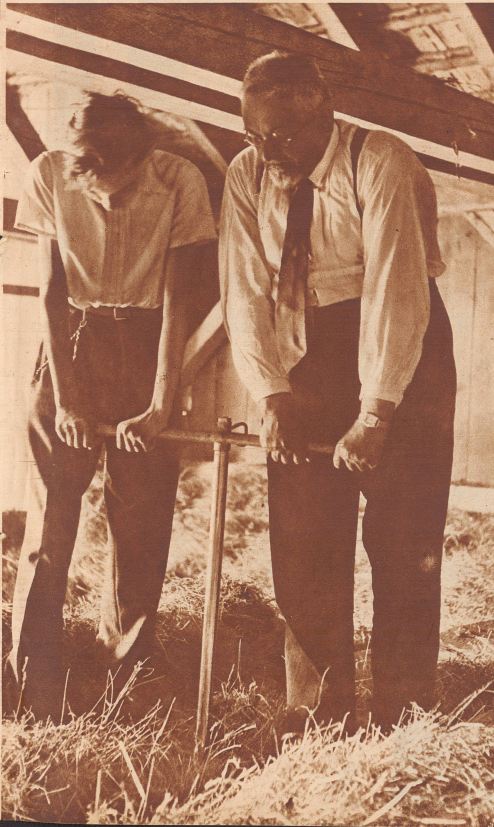
Links: Mittels der Heusonde wird ein verdächtiger Heustock angestochen, um eine allfällige Ueberhitzung festzustellen. Die Sonde besteht aus einem Eisenrohr mit konisch auslaufender Schneide, das je nach der Höhe des Heustockes verlängert werden kann. Das Anstechen hoher Stöcke erfordert große Kraftanstrengung.
