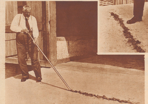
Die mit der Sonde ausgestochene Probe wird mit Hilfe eines Holzstabes ausgestochen. Die Probe besteht aus einem stark zusammengepressten wurmförmigen Gebilde aus Heu.
