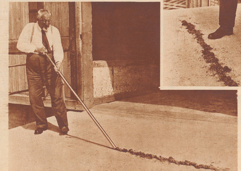
Die mit der Sonde ausgestochene Probe wird mit Hilfe eines Holzstabes ausgestoßen. Die Probe besteht aus einem stark zusammengepressten wurmförmigen Gebilde aus Heu.
