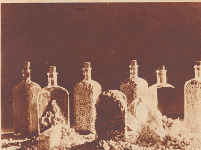
Quellende Erbsen vermögen dickwandige Glasflaschen zu sprengen. Das Wasser dringt ins Innere der Erbsen ein, mit unwiderstehlich wachsendem Druck pressen die immer größer werdenden Kugeln gegen das feste Glas, bis dieses nachgibt und bricht.
