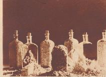
Quellende Erbsen vermögen dickwandige Glasilaschen zu spren-gen. Das Wasser dringt ins Innere der Erbsen ein, mit unwider-stehlich wachsendem Druck pressen die immer größer werdenden Kugeln gegen das feste Glas, bis dieses nachgibt und bricht.
