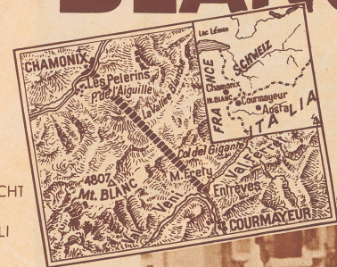
Karte vom Mont-Blanc-Gebiet mit der eingezeichneten geraden 12,5 Kilometer langen Tunnelverbindung vom französischen Chamonix zum italienischen Val Ferret.
