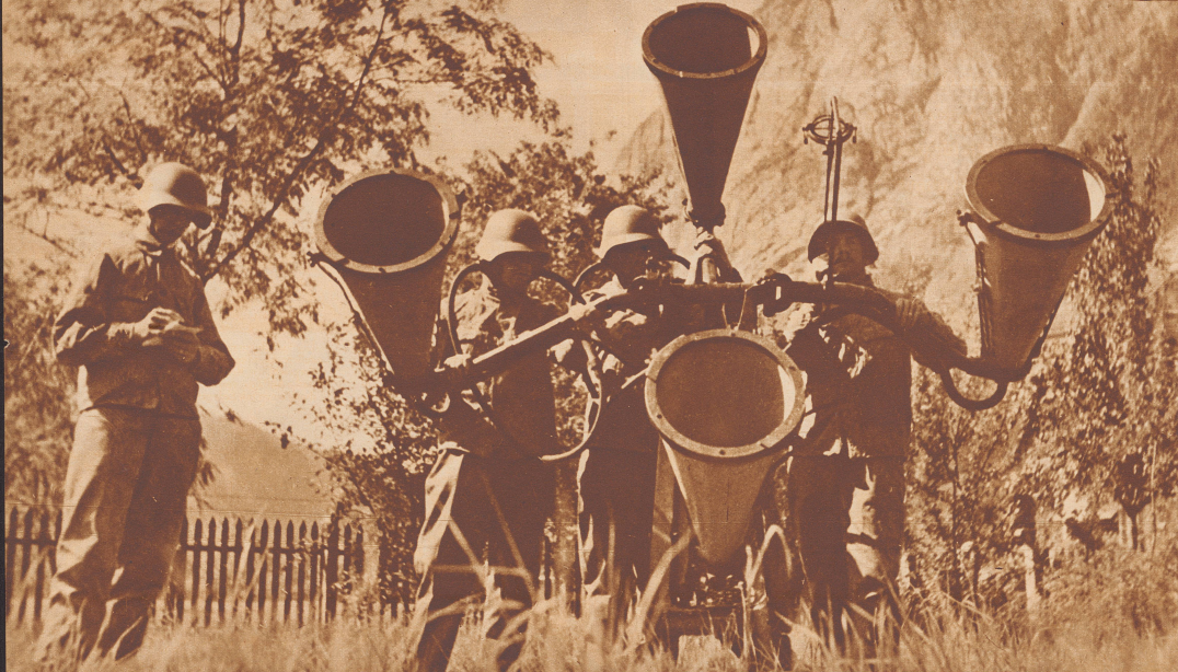
Horchgerät, das jetzt in der Armee neu eingeführt wurde. In der Kriegszeit sind alle wichtigsten Beobachtungsposten mit dem Apparat ausgerüstet. Er ermöglicht es, Motorengeräusch auf 150 bis 200 Kilometer Distanz wahrzunehmen und so das Herannahen feindlicher Flieger festzustellen, lange bevor sie sichtbar sind. Der Beobachtungsposten meldet sofort seine Wahrnehmung an die Alarmposten weiter, diese setzen die Sirenen in Tätigkeit, und die Bevölkerung weiß, daß sie sich in den Luftschutzraum begeben muß.
