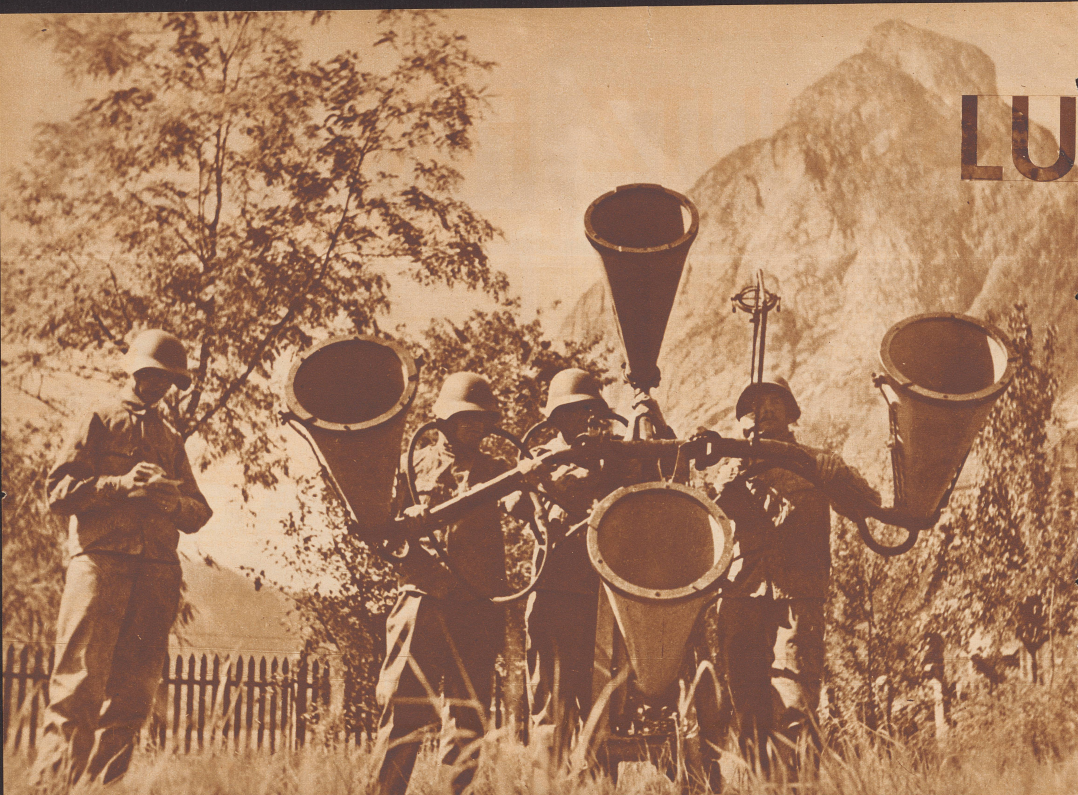
Horchgerät, das jetzt in der Armee neu eingeführt wurde. In der Kriegszeit sind alle wichtigsten Beobachtungsposten mit dem Apparat ausgerüstet. Er ermöglicht es, Motorengeräusch auf 150 bis 200 Kilometer Distanz wahrzunehmen und so das Herannahen feindlicher Flieger festzustellen, lange bevor sie sichtbar sind. Der Beobachtungsposten meldet sofort seine Wahrnehmung an die Alarmposten weiter, diese setzen die Sirenen in Tätigkeit, und die Bevölkerung weiß, daß sie sich in den Luftschutzraum begeben muß.
