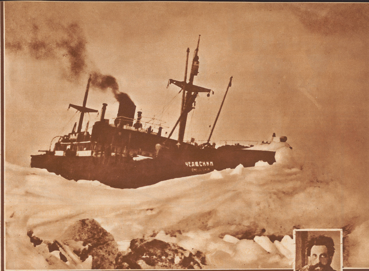
Der «Tscheljuskin» fünf Stunden vor dem Untergang. Am 12. Februar 1934, morgens früh, begann der Dampfer dem Eisdruck zu erliegen. Die Eisschollen bohrten sich förmlich in den unter Wasser liegenden Teil des Schiffes ein und schälten die Metallpanzerung vom Rumpfe ab. Das Wasser drang ein, löschte das Feuer unter den Kesseln und überschwemmte die Räume. Nachmittags 3 Uhr sank der «Tscheljuskin». 68,25 Grad nördlicher Breite, 173,9 Grad östlicher Länge, 200 Kilometer nördlich von Kap Wankarem liegt das Wrack 55 Meter tief auf dem Grund des Sibirischen Meeres.
