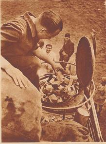
Der Generator ist mit gewöhnlichen Tannen- oder Lärchenholz-würfeln gefüllt. Jedoch ist jede andere Holzart auch verwendbar. Eine einzige Füllung von 100 kg reicht aus zu einer Fahrt was 30–100 km. Mittels mit Benzin getränkter Putzfäden wird das Holz entzündet. Nach vier Minuten ist der Wagen fahrbereit. Diese Zeit ist nötig zur Entwicklung der Holzgase. Der Motor ist ein regulärer Benzinmotor mit kleinen Abänderungen.
