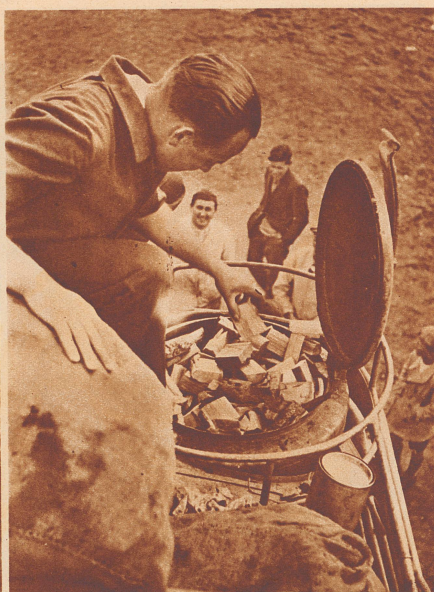
Der Generator ist mit gewöhnlichen Tannen- oder Lärchenholzwürfeln gefüllt. Jedoch ist jede andere Holzart auch verwendbar. Eine einzige Füllung von 100 kg reicht aus zu einer Fahrt von 80–100 km. Mittels mit Benzin getränkter Putzfäden wird das Holz entzündet. Nach vier Minuten ist der Wagen fahrbereit. Diese Zeit ist nötig zur Entwicklung der Holzgase. Der Motor ist ein regulärer Benzinmotor mit kleinen Abänderungen.
