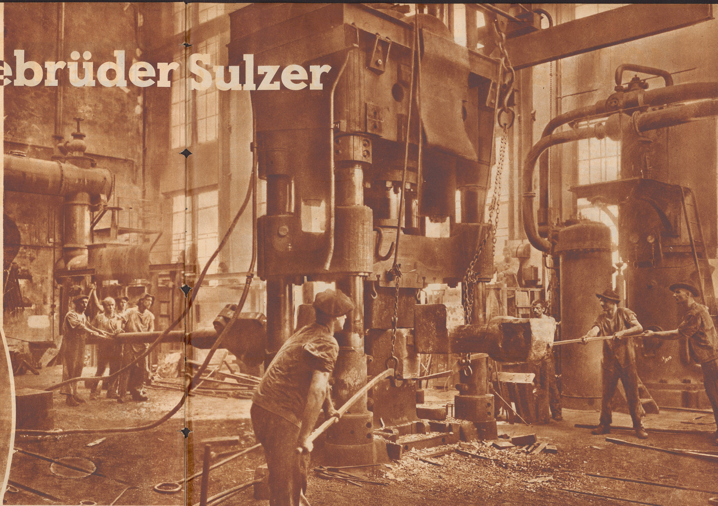
Aus den Sulzer-Werkstätten in Winterthur. Hydraulische Schmiedepresse von 1000 Tonnen Druck, zum Schmieden von Kurbelwellen und andern großen Stücken
