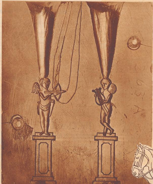
Die vordere Seite einer Gußform für Zinnsoldaten. Durch die beiden trichterförmigen Kanäle wird das flüssige Zinn in die Form gegossen. Die beiden schnurförmigen Kanäle zwischen den Figuren dienen der beim Eingießen des heißen Zinnes entweichenden Luft als Ausgang.
