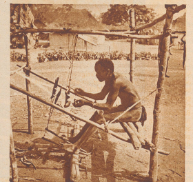
Baule-Bandweber am primitiven Webstuhl. Er verarbeitet selbstgesponnenes Baumwollgarn aus selbstgeplanter Baumwolle.
