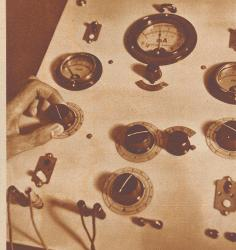
Die Hand des Messenden stellt die für jede Versuchsperson individuelle Meßspannung ein, wonach dann erst die eigentliche Messung beginnen kann. Das große Milliamperemeter in der Mitte oben zeigt die Meßwerte an, die beim Durchgang des Stromes durch die einzelnen Reaktionsfelder erzielt werden. Die Meßwerte werden in einem sogenannten Persönlichkeitsprofil vereinigt und zu einem Psychogramm ausgewertet.
