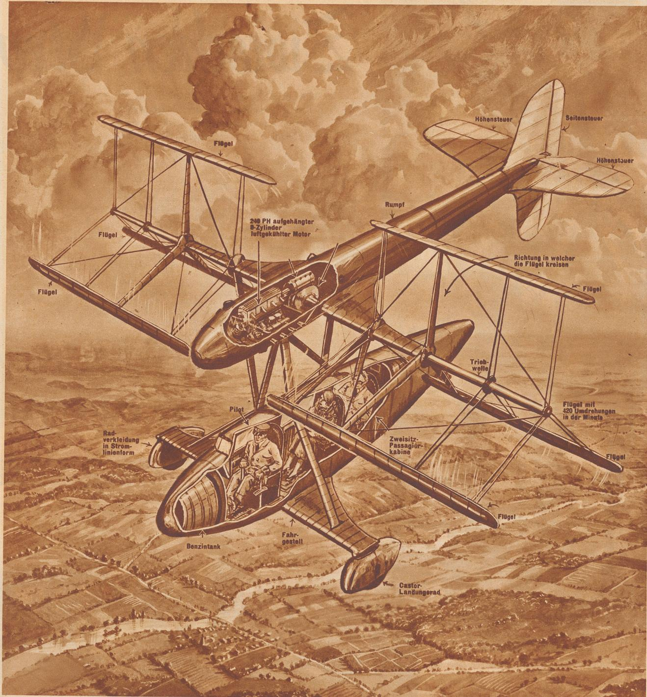
Das Schaufelrad-Flugzeug erhebt sich ohne Anlauf senkrecht in die Luft. Das angewandte System ist leicht verständlich: zwei Flügelgruppen, bestehend aus drei schmalen, miteinander verbundenen Flügeln, werden durch einen 240 PS-Motor zu 420 Umdrehungen pro Minute angetrieben. Wenn diese Schmalflügel kreisen, wird durch eine einfache Betätigung eines Hebels Vorförwärtsbewegung, Schwebeflug und sogar Rückwärtsflug ermöglicht.
