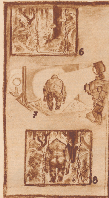
6. Zuerst wird der richtige Urwald im Film aufgenommen, ohne daß man aber den Film entwickelt. Dieser exponierte, aber nicht entwickelte Streifen, wird wieder in die Aufnahme-Kamera zurückgelegt. 7. Rote Lichtquelle wirft rotes Licht auf einen durchscheinenden Schirm. Der Film, auf dem bereits die noch unentwickelten Urwaldbilder liegen, nimmt nun noch im blauen Licht King Kongs Bild auf, d. h. den Schauspieler im Affenkostüm. Das rote Licht auf dem Schirm stört die Urwaldaufnahmen nicht, da der Film für rotes Licht unempfindlich ist. 8. Der nunmehr entwickelte, zweimal exponierte Film, zeigt auf dem Urwaldbühnenhintergrund die Riesengestalt King Kongs im richtigen Verhältnis.
