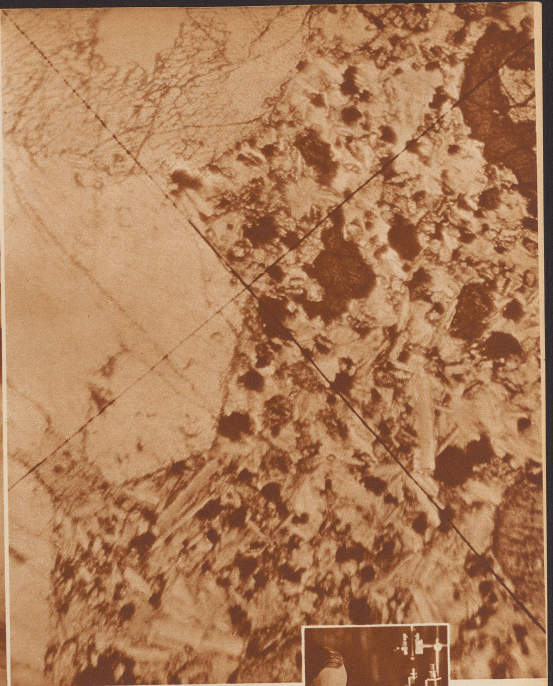
Die Spinne im Dienste der Chemie. Das ist die Vergrößerung eines sehr dünnen Blättchens von Feldspat, der aus verschiedenen Elementen besteht. Um diese Elemente zu identifizieren, werden mit Hilfe des Fadenkreuzes eines Meßmikroskops die Winkel der einzelnen Kristalle dieser Elemente bestimmt. Da bestimmte Substanzen immer dieselben Kristalle mit gleichen den Wissenschaftlern bekannten Winkeln bilden, so ist es nach Feststellung dieser Winkel ein Leichtes zu sagen, mit welcher Substanz man es jeweils zu tun hat. Auf dem Bilde ist das Fadenkreuz genau auf die eine Seite eines größten Kristalls (links) eingestellt, durch Drehung erfolgt dann die Berechnung des dazugehörigen Winkels.
